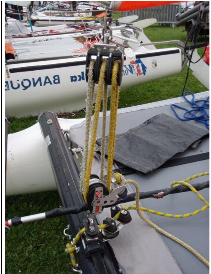
Détail du palan de GV
