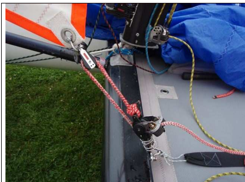
Détail du système de réglage de foc
