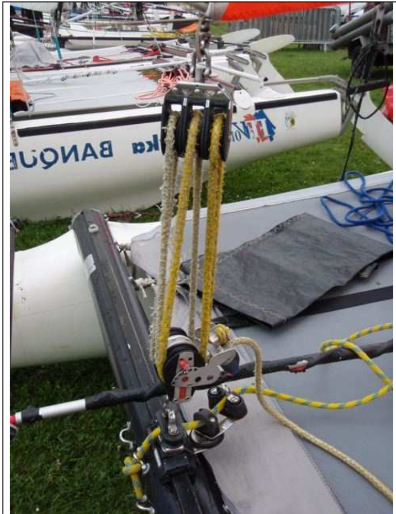
Détail du palan de GV
