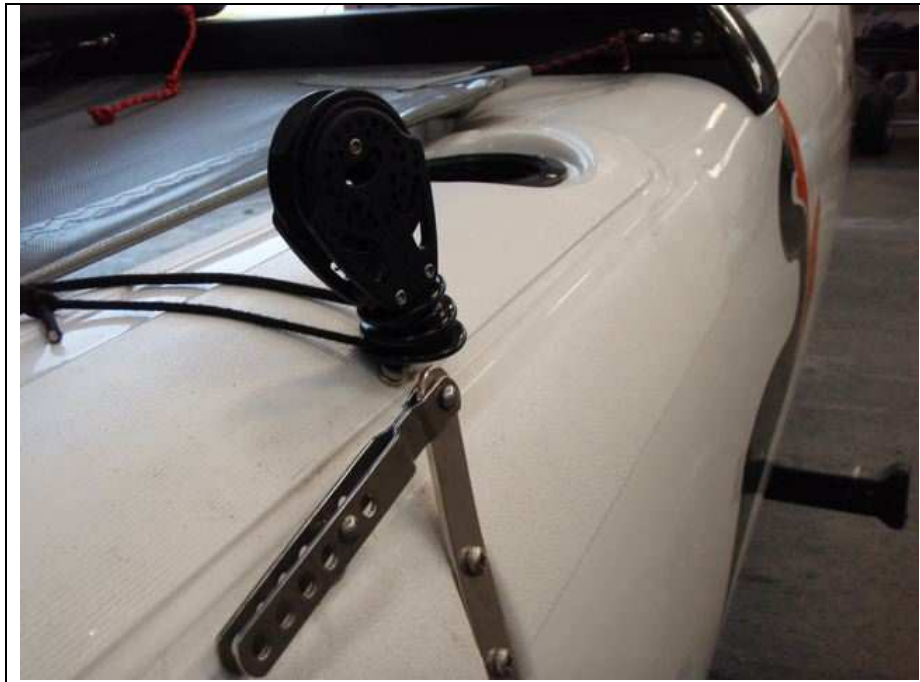
Détail du positionnement des poulies de spinnaker
